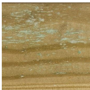
Bois traité autoclave avec quelques taches laissé par le sel du traitement.
